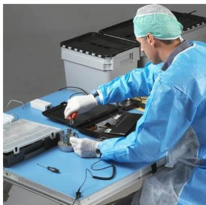
Le tapis antistatique Anti Stat POP se pose sur les tables de travail pour dissiper l'électricité statique des objets conducteurs et ainsi protéger les employés et les équipements électriques sensibles.
